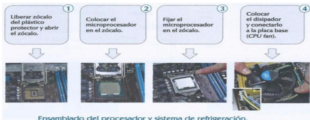
El primer paso en la instalación de un procesador es liberar el zócalo del protector de plástico (en caso que sea LGA), si es que tiene los pines en la placa base. Al retirar este cobertor de pines, tiene que abrirse la trampilla para recibir el microprocesador.
