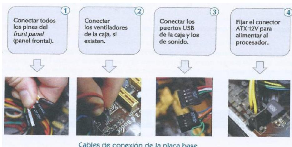
Uno de los pasos que hay que dar en la instalación de una placa base es la instalación de los cables del panel frontal (front panel). Entre estos cables hay que tener en cuenta que hay algunos leds.
